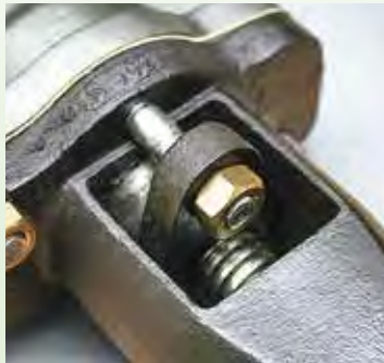
Stopfbüchse, Abdichtung mit Stopfschnüren
