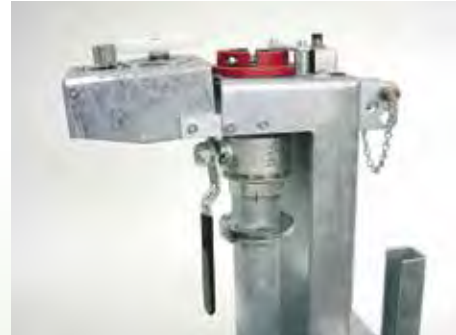
Kunststoffzwischenrad nimmt Schläge auf und schützt den Getriebemotor
